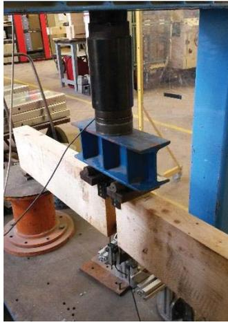
*'Fig. 1' Pull-bending test*
